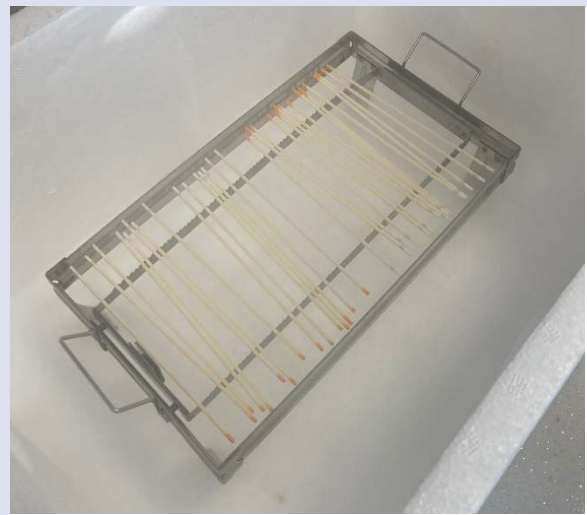
Şekil 1. Sıvı azot seviyesinin 5 cm yukarısında taraklara dizilmiş payetlerin 7 dakika sürede dondurulması ve sıvı azot içine atılması işlemi Figure 1. The process of freezing the straws lined up on combs 5 cm above the liquid nitrogen level in 7 minutes and throwing them into liquid nitrogen.
